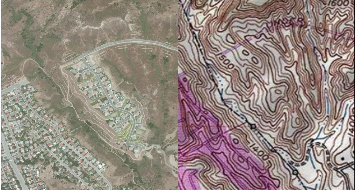
الشكل ٥،٣: رسومات النقطية الشائعة المستخدمة في تطبيقات نظم المعلومات الجغرافية: صورة جوية (يسار) و USGS DEM (يمين) (المصدر: البيانات المتاحة من المسح الجيولوجي الأمريكي، مركز رصد موارد الأرض والعلوم (EROS)، شلالات سيو، SD.
